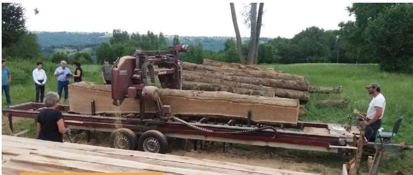
Figure 1: scie débitant des planches de 0.02x5m
